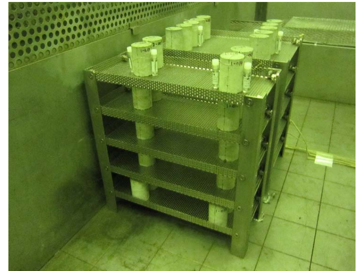
コンクリート物理特性試験 (試験体を照射室内で曝露)
