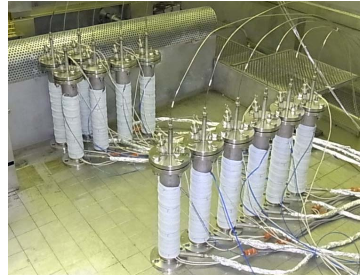
セメントペースト相互作用試験 (ステンレス容器に封入して照射し、発生ガスを捕集)
