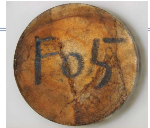
照射後の骨材の様子 ひび割れが見られる
