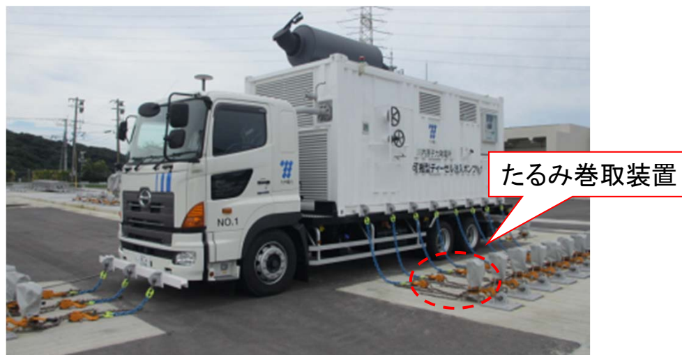
たるみ付き固縛の例 (可搬型ディーゼル注入ポンプ)
